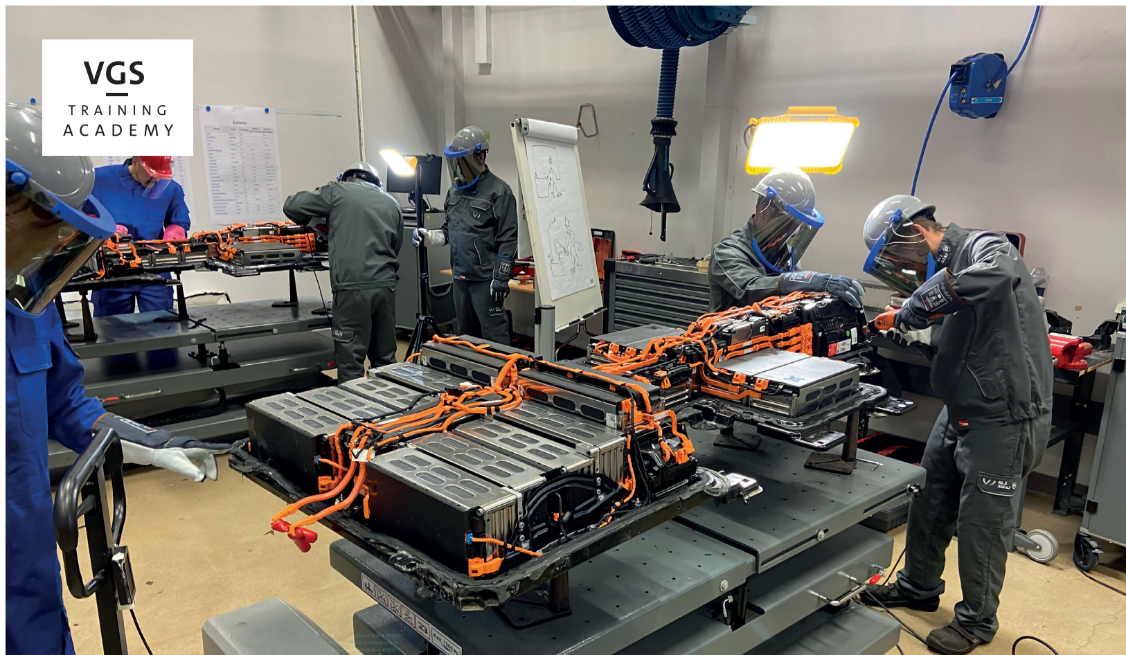
Framtidens mekaniker. Elever i full fart med att hantera högvoltbatterier. Här bearbetar man batteriets bottendel för att limma dit en ny överdel. Bild från VGS Training Academy utbildningslokaler.
